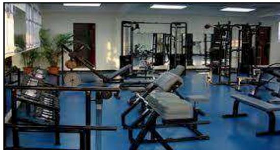
Esta actividad comprende el suministro e instalación de cubrimiento epóxico, autonivelante a 2 mm, conformado por: Imprimación epóxica, mortero resina epóxica + Agregados de Cuarzo.
