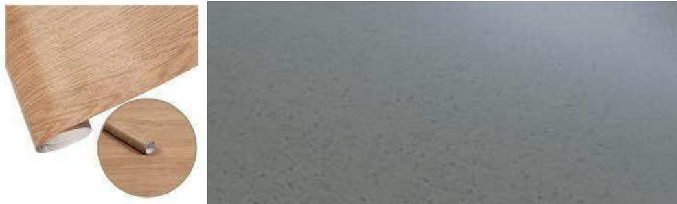
Piso vinílico (PVC) heterogéneo compacto, antiestático y antibacterial, para tráfico intenso, medidada .80 cm x .80, con un espesor de 2mm, capa de uso de 0.70mm. Instalado con adhesivo y cordón de soldadura especializado recomendado por fábrica.
